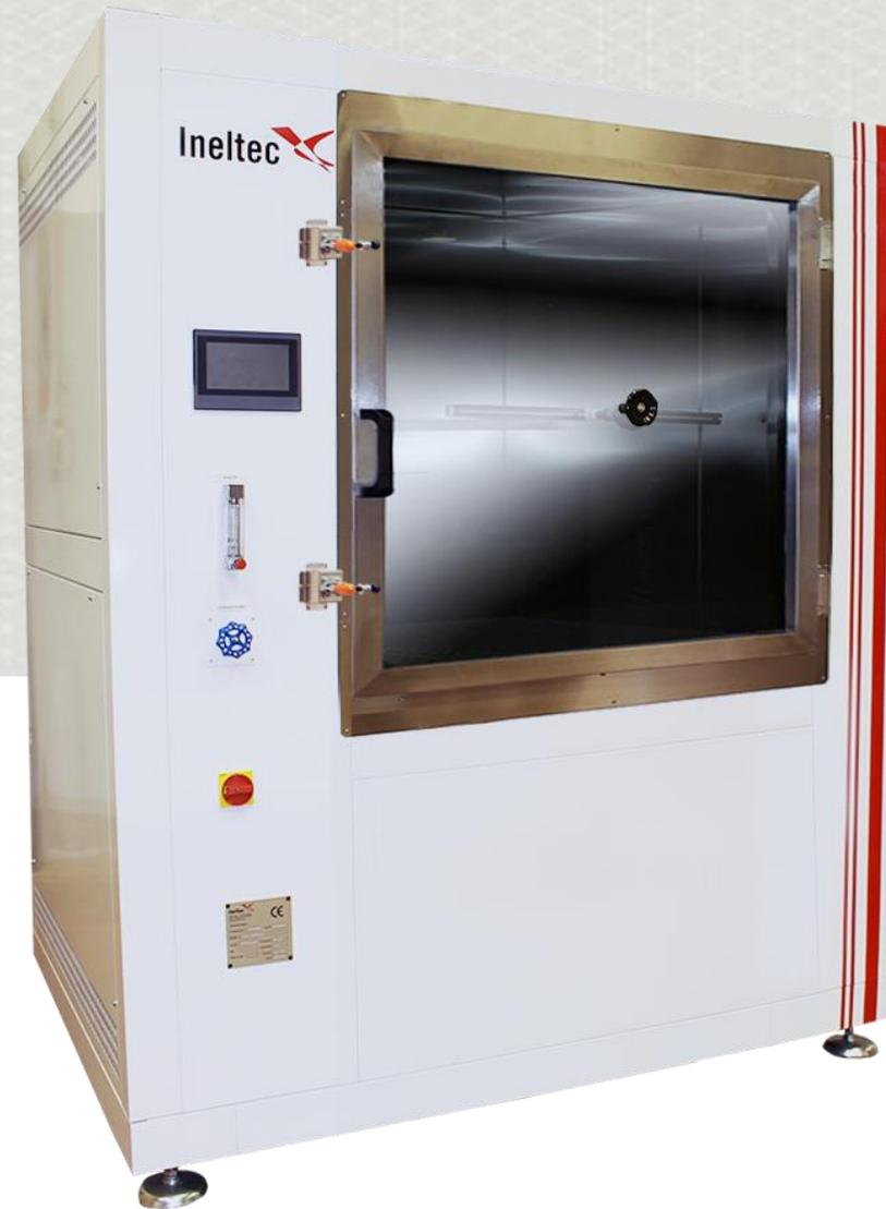
Las cámaras de estanqueidad al polvo que fabrica Ineltec realizan ensayos según normas internacionales.
